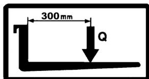
La charge doit être répartie régulièrement et soutenue par les deux longerons.
